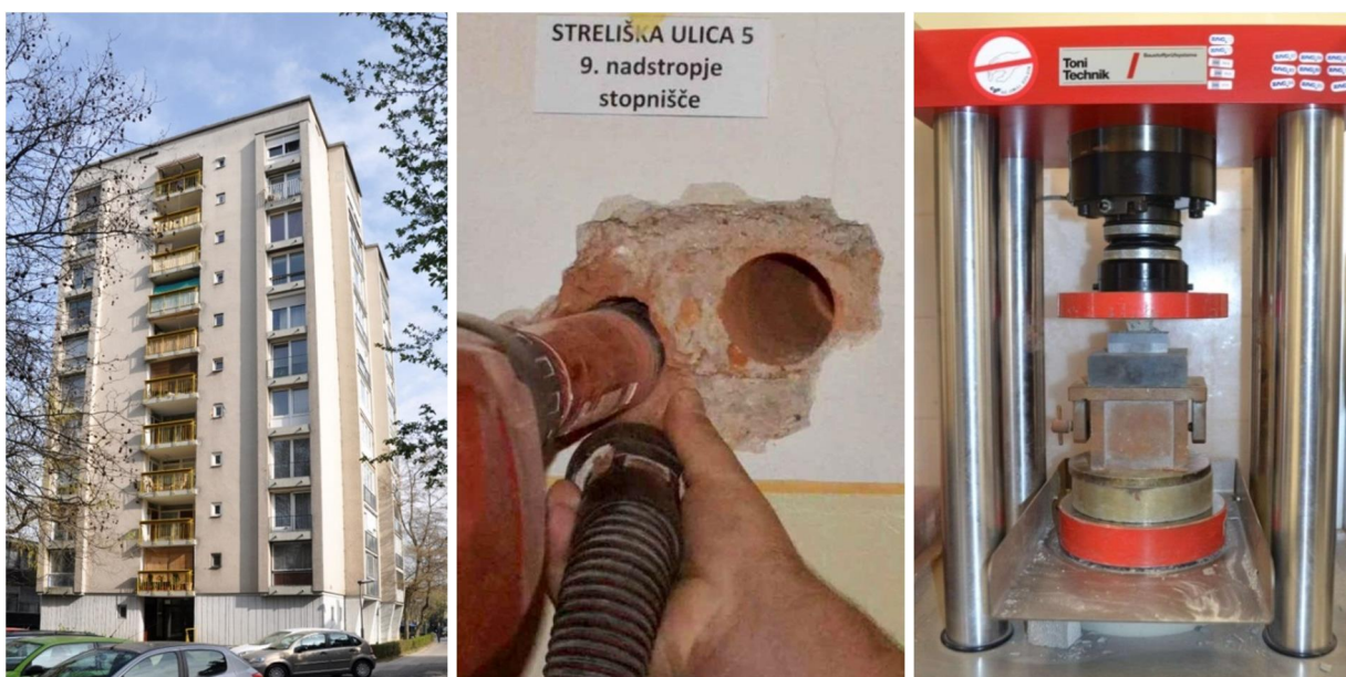
Slike 2.1. Tip A: ena od stolpníc (levo), odvzem vzorcev opeke in malte (sredina) in tlačni preskus vzorca malte (desno).
