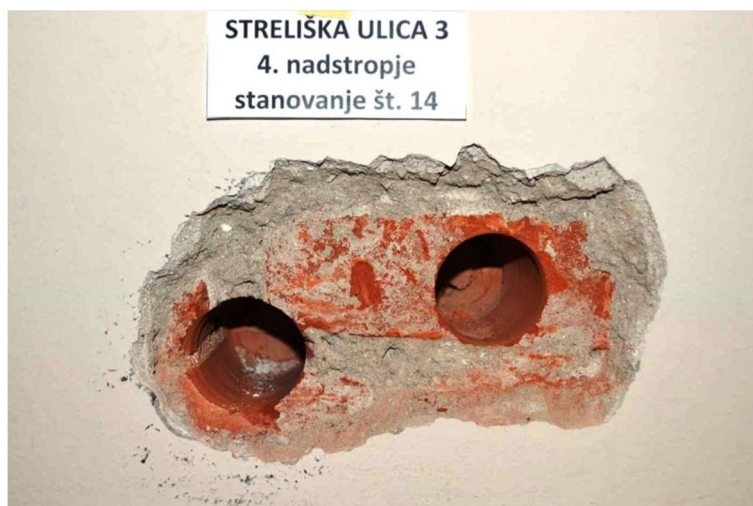
Slika 4.2: Pregledno mesto S3/N4/14 po odvzemu valjnega vzorca iz opešnega zidaka (desno) in valjnega vzorca preko vodoravne in navpične spojnice - za pridobitev vzorca malte.
