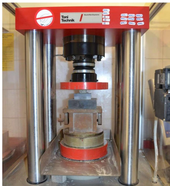
Slika 4.5: Vzorec malte z mesta H2/N2/8 med preiskavo tlaž ne trdnosti.
