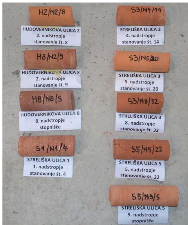
Slika 4.3: Odvzeti valj ni vzorci iz opeł nih zidakov za tlaž ne preskuse.
